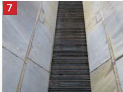
7 Montage de tuiles sans encoche pour éviter la perte de fines (tuiles sur-mesure fabriquées à la dimension)
