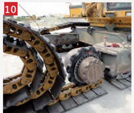
Remontage des chaînes : déroulement des chaînes devant la pelle pour les monter dans le bon sens
