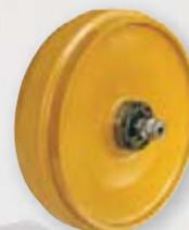
Une fuite du joint de la roue folle peut entraîner une détérioration totale de la pièce et un arrêt obligatoire.
