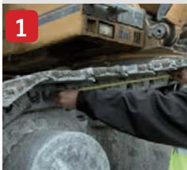
Relevé des cotes d'usure de chaque composant du train de roulement (voir p. 10-11) avec prise en compte de l'environnement de travail de la machine, des équipements utilisés (lames, ripper...) et du type de travail.
