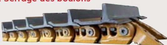
Un mauvais couple de serrage peut entraîner la perte des tuiles, l'ovalisation des trous de fixation sur les maillons et l'ouverture des chaînes en cas de maillons crantés.
