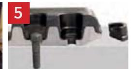
**5** Clipsez les bouchons SACLIP® dans la collerette du patin SACATEC®. Conformez-vous à un enfoncement à état neuf de 18 mm environ pour limiter la perte des bouchons
