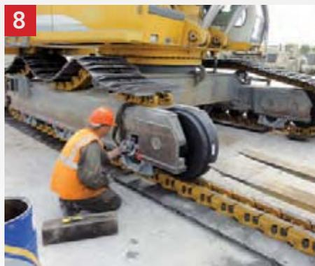
Changement des joints sur le tendeur de la roue folle puis remontage des roues sur la machine
