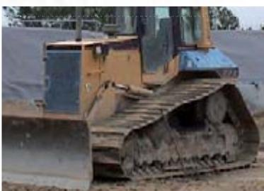
Une machine équipée de tuiles dites «marais» peut les supporter car le terrain sur lequel elle évolue permet une répartition uniforme des charges sur toute la largeur.
