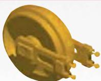
Située à l'opposé du barbotin, la roue folle permet de régler la tension de la chenille caoutchouc. Il est essentiel de maintenir une tension correcte tout au long de l'utilisation.
