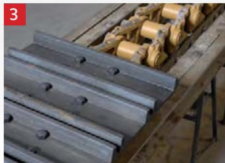
3 Pose des patins puis approche des vis et écrous (face arrondie de l'écrou vers l'extérieur).
