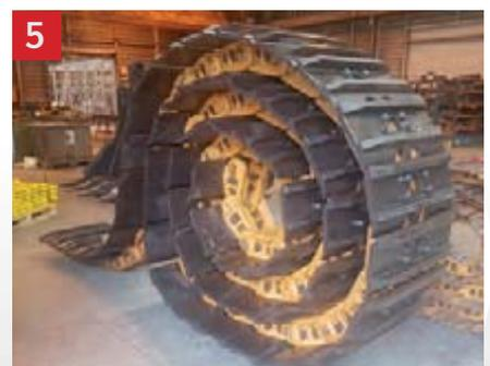
5 Enroulement de la chaîne pour le transport
